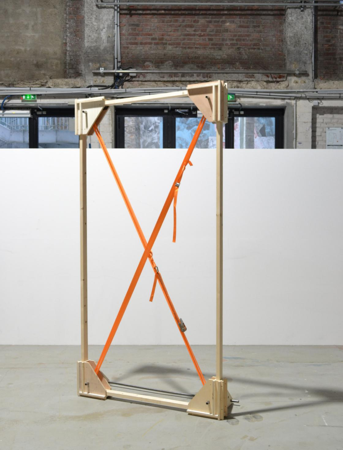
*Le châssis peut être aussi utilisé ouvert, maintenu par une sangle.
